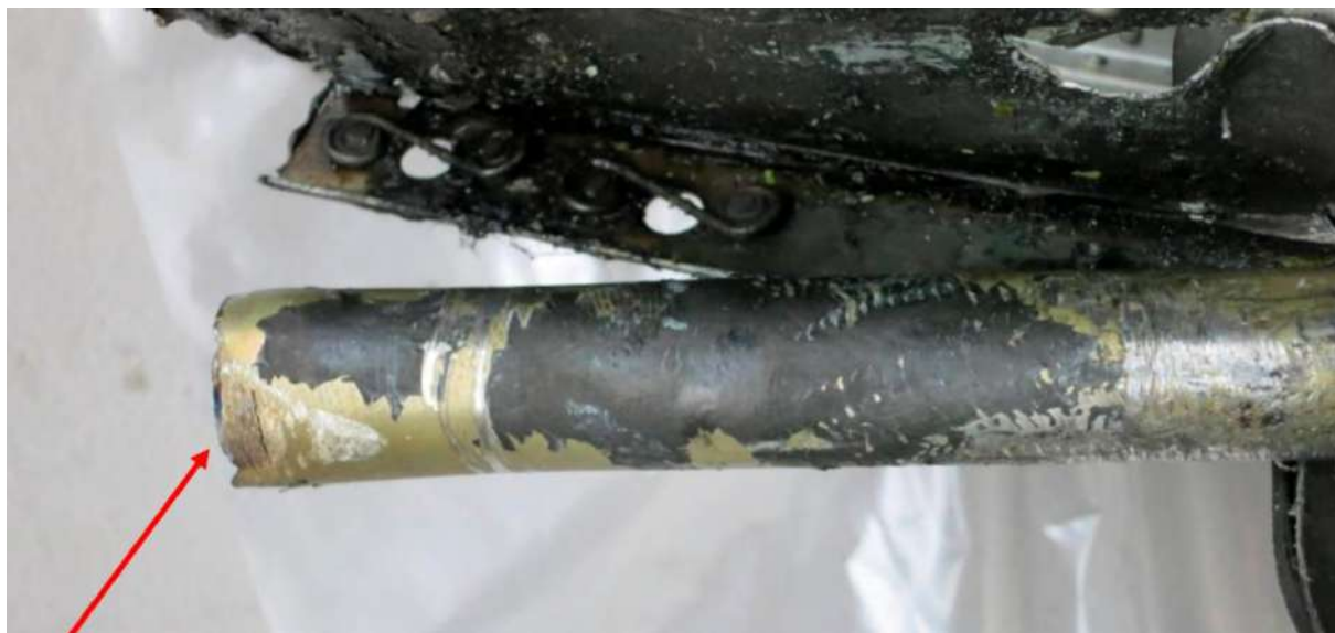
Рис. 6 Состояние хвостового вала (стрелкой указано место обрыва)
