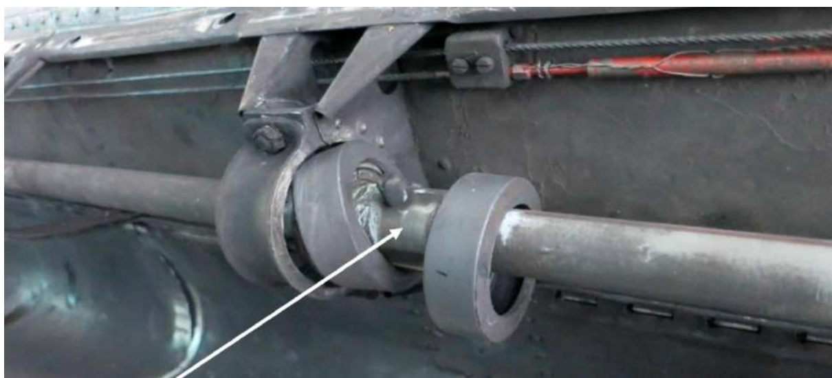
Рис. 6 Состояние хвостового вала (стрелкой указано место обрыва)
