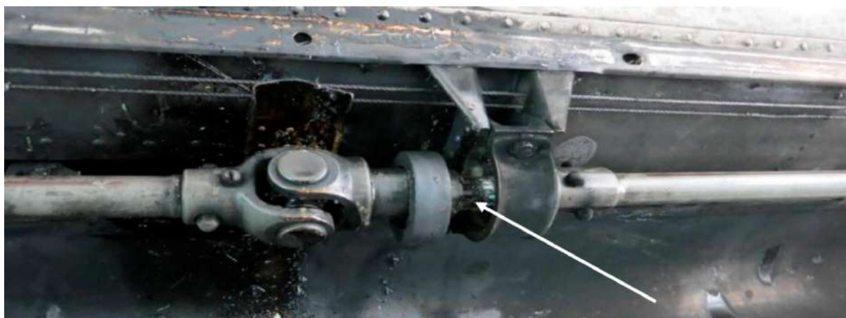
Рис. 7 Повреждения мест крепления опор хвостового вала (указано стрелками)
