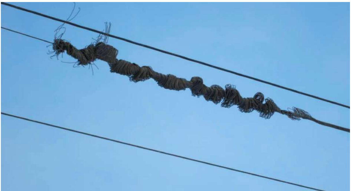
Рис. 17 Место повреждения провода ЛЭП лопастью несущего винта
