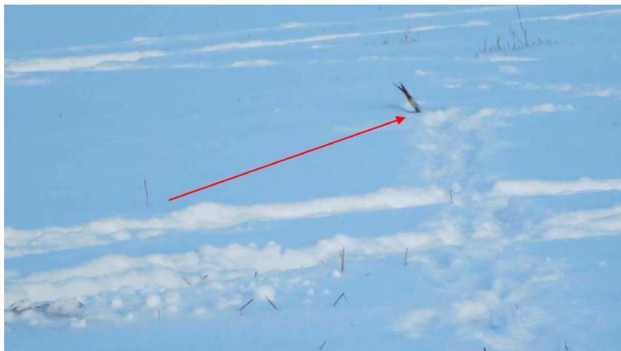
Рис. 19.Фрагменты разрушенных лопастей хвостового винта (указано стрелкой)
